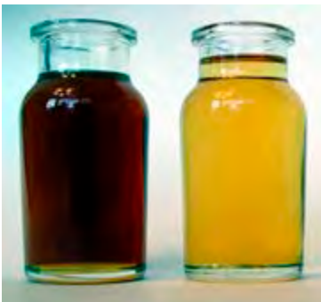
Rysunek 12: Zdegradowany olej hydrauliczny w porównaniu z nowym Źródło: C.C.JENSEN A/S
