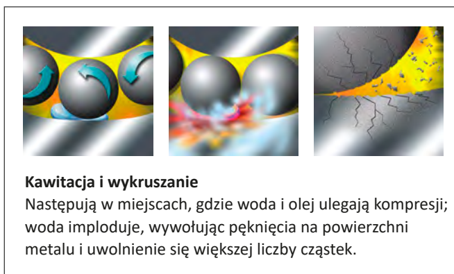
Rysunek 4: Kawitacja i wykruszenie
