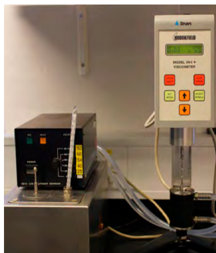
Rysunek 13: Wiskozymetr mierzy lepkość kinetyczną (cSt)
